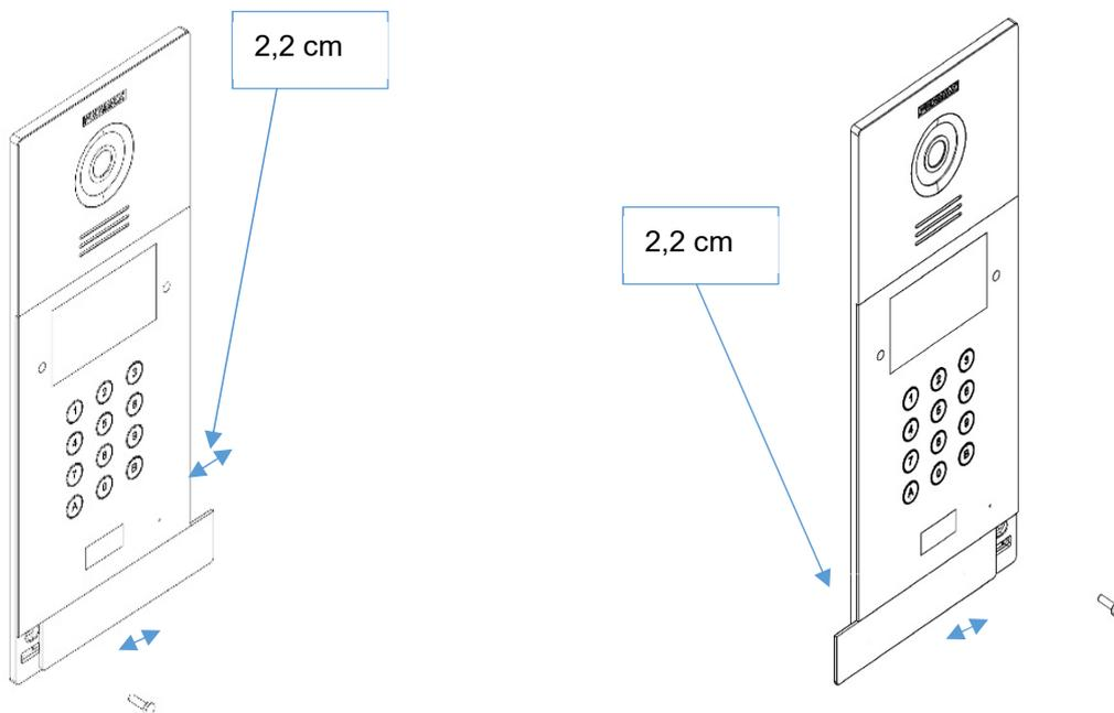
4. Mueva la pestaña deslizante de la placa y fije los dos tornillos. En la instalación se debe prestar atención para asegurarse de que se dejan 2,2 cm de espacio libre alrededor de la puerta la desplazar la cubierta deslizante.
