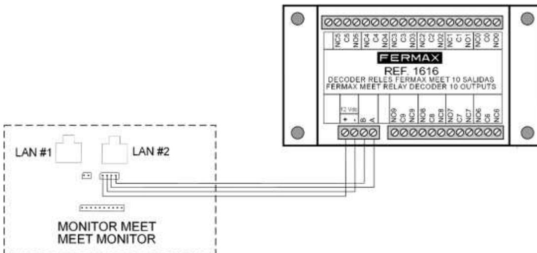
Para la activación de los dispositivos a controlar, utilizar las salidas de relé 0 a 7, correspondiendo con las activaciones R1 a R8 de la pantalla de control del monitor. Las salidas de relé 8 y 9 no se utilizan.
