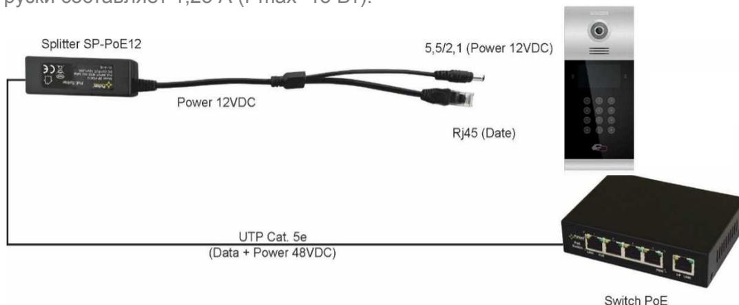
Напряжение питания (Power) и данные (Data) подаются на вход модуля (разъем RJ-45) от устройства PoE. Данные (Data) передаются только на выход (штекер RJ-45), в то время как напряжение питания 12 В постоянного тока подается на штекер 5,5/2,1.
