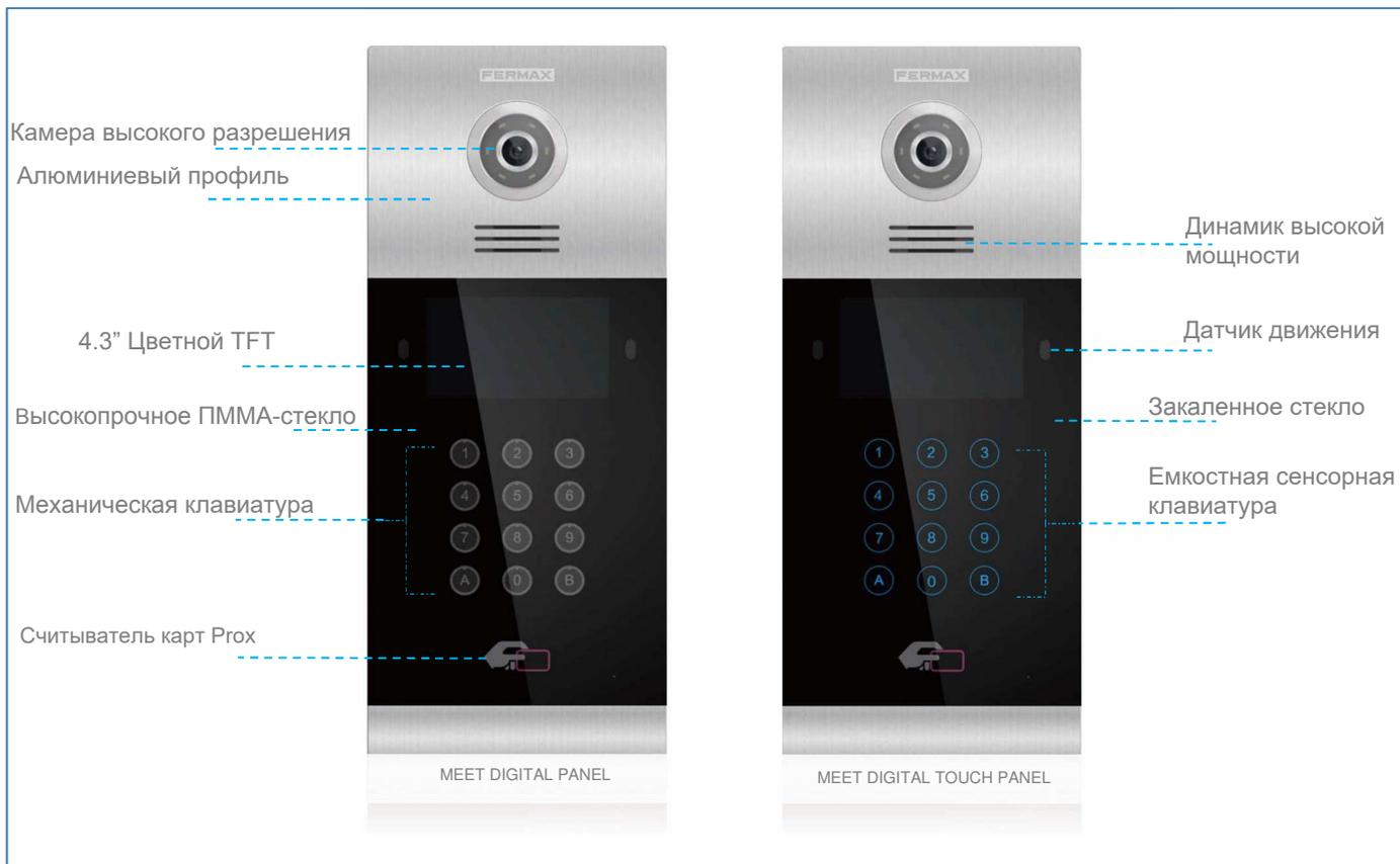
Панель MEET представлена в двух вариантах исполнения: емкостная сенсорная клавиатура и механическая клавиатура. Его 4,3-дюймовый TFT-экран показывает пользователю необходимые шаги.
