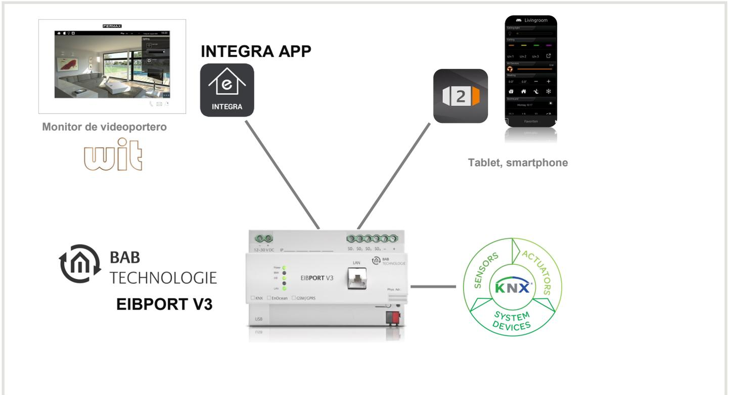
Del mismo modo en que la domótica puede ser controlada usando un smartphone o tablet, la App INTEGRA se puede utilizar con el monitor WIT gracias a su sistema operativo basado en Android. De esta manera podemos ofrecer un control fijo y centralizado en la instalación.
