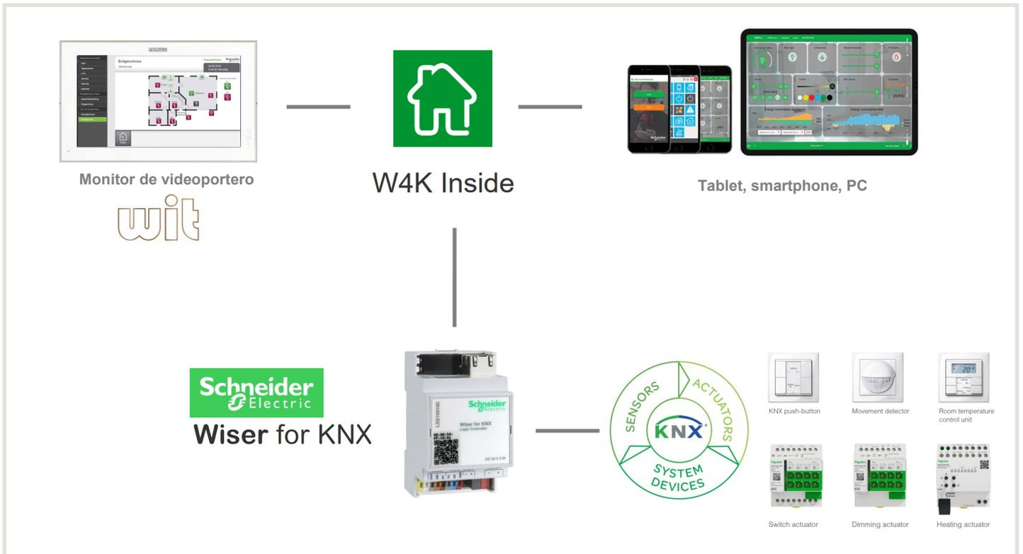
Del mismo modo en que la domótica puede ser controlada por la App W4K usando un smartphone o tablet, la App Schneider W4K Inside App se puede utilizar con el monitor WIT gracias a su sistema operativo basado en Android. De esta manera podemos ofrecer un control fijo y centralizado en la instalación.
