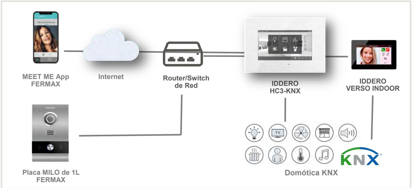
La placa envía la llamada a las pantallas IDDERO mediante el protocolo SIP. De esta manera la pantalla puede recibir la llamada y mostrar el video enviado por la placa mediante el protocolo RTSP. La puerta de la calle se puede abrir gracias a un comando programado desde la pantalla.
