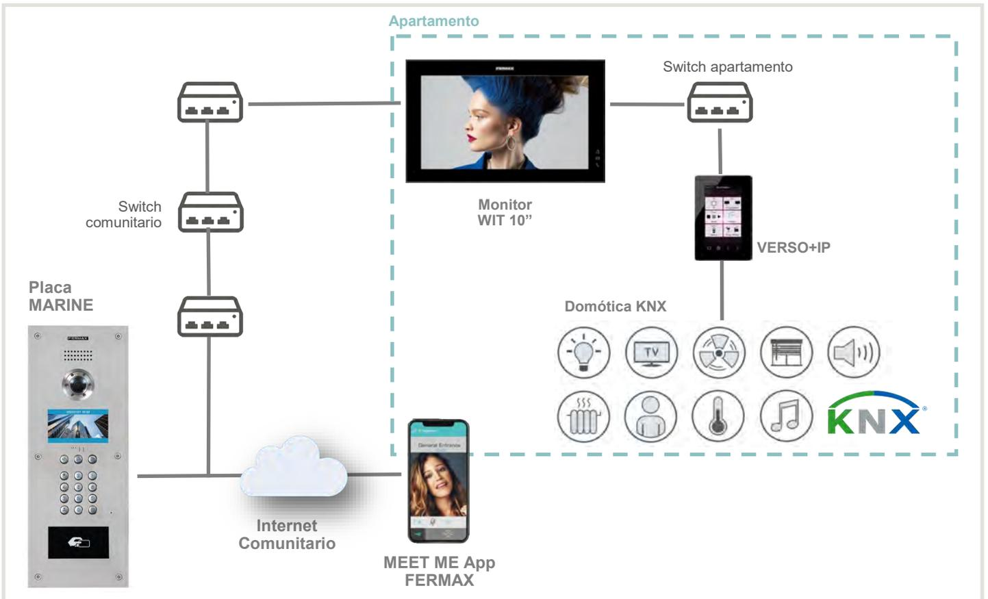
La llamada de videoportero llega al monitor WIT. Desde el controlador de estancia VERSO+IP es posible controlar la domótica. Gracias al servidor embebido en VERSO+IP, el monitor de FERMAX WIT puede gestionar la domótica KNX instalando la app IDDERO MOBILE.
