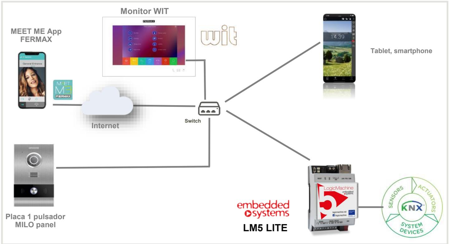
Del mismo modo en que la domótica puede ser controlada usando un smartphone o tablet, la App FERMAX INTEGRADA se puede utilizar con el monitor WIT gracias a su sistema operativo basado en Android 10. De esta manera podemos ofrecer un control fijo y centralizado en la instalación.
