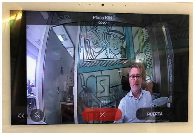
Al recibir la llamada se visualizará la imagen capturada por la cámara de la placa de calle y al pulsar el botón de contestar se abrirá el canal de audio bi-direccional. La temporización está limitada a 120". Se tiene la opción de realizar la apertura de puerta en cualquier momento.
